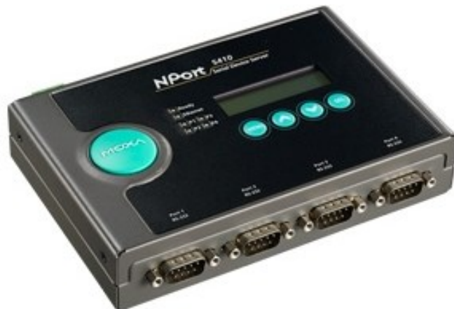
Рисунок 24 – Асинхронный сервер RS/Ethernet NPort 5410
